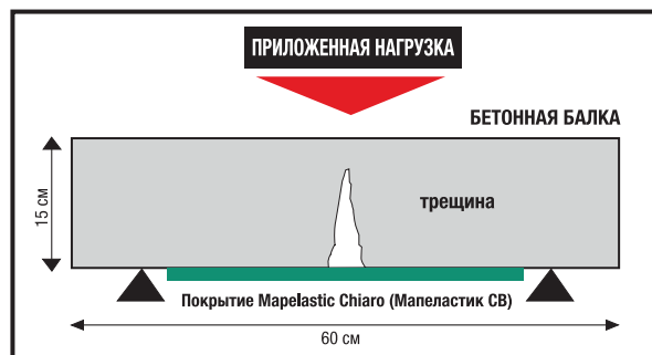
Рисунок 1. Защита трещины с помощью Mapelastic Chiaro (Мапеластик СВ) на нижней грани бетонной балки, подверженной изгибающей нагрузке
